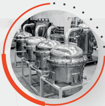
Фильтровальное оборудование (фильтры аэрозольные, фильтры йодные, установка пылеулавливания)
